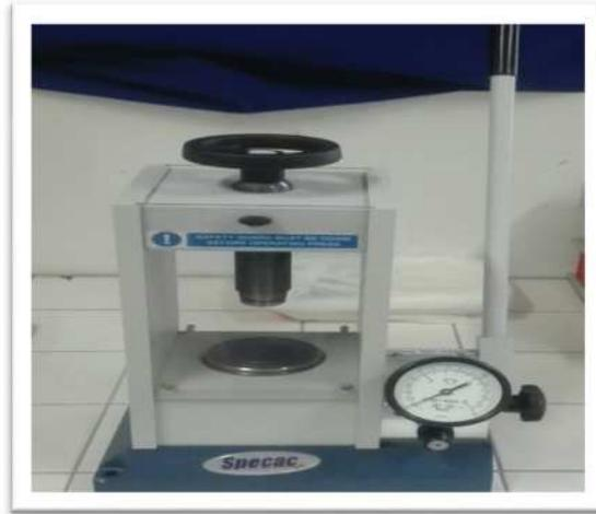
**Figure 12 : Presse hydraulique.**
