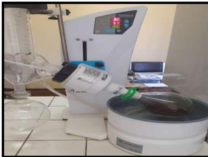
**Figure 25** : Evaporation sous vide à sec (évaporateur rotatif).
