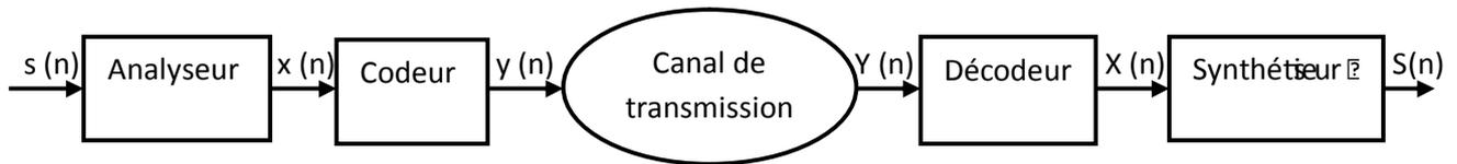
**Figure III.2** Système de compression élémentaire.
