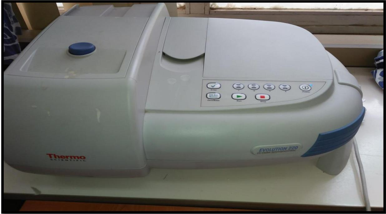
**Figure 3 :** Spectromètre UV-Visible Thermo Scientifique 64606/SDMM/1
