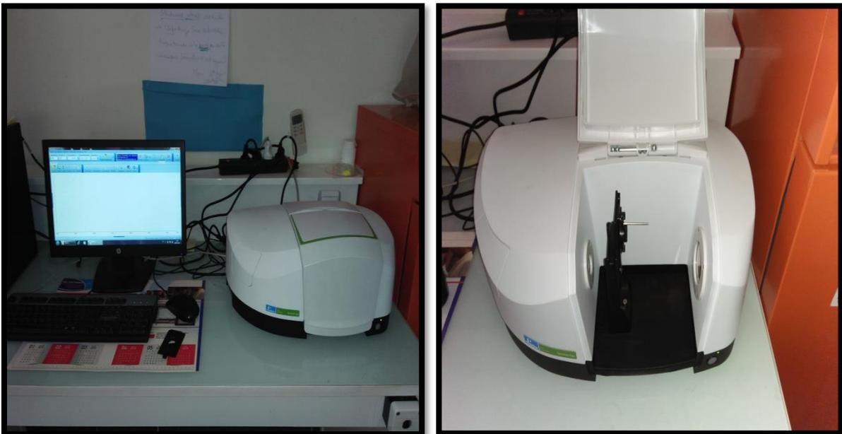
Figure 2 : Spectromètre Infrarouge PerkinElmer FT-IR Life and Analytical Sciences
