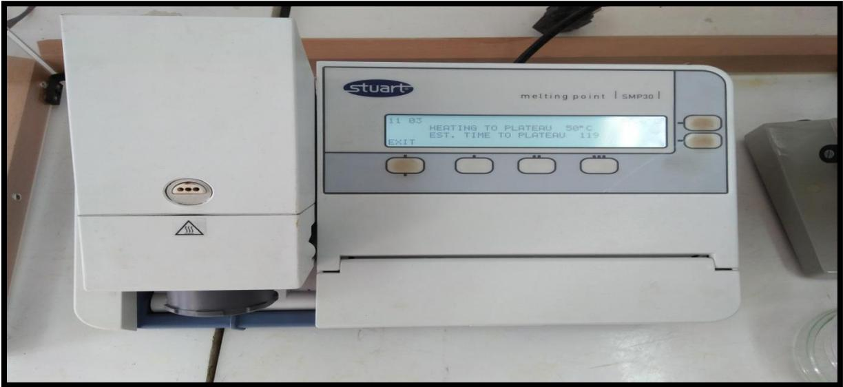
Figure 1 : Appareil digital de type Melting point Apparatus, SMP30
