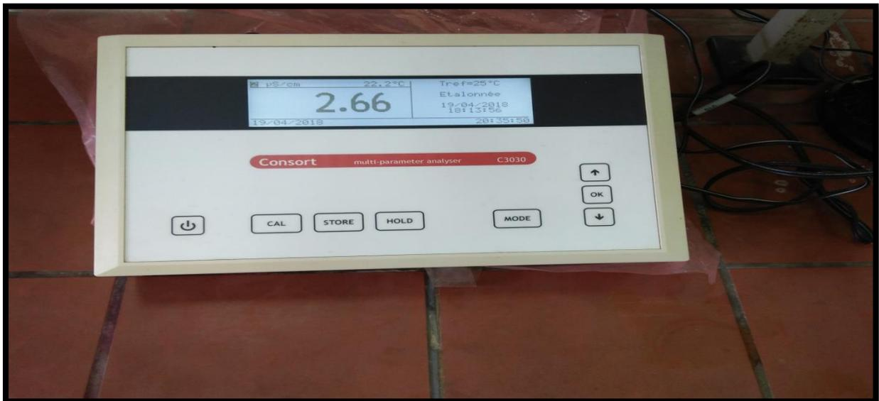
**Figure 4 :** Conductimètre de type Consort C3030
