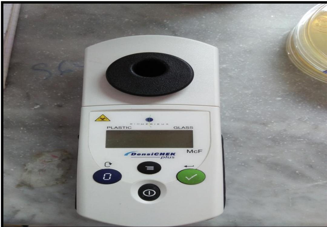
**Figure 6 :** Densitomètre de type DensiCHEK plus (BIOMERIEUX)
