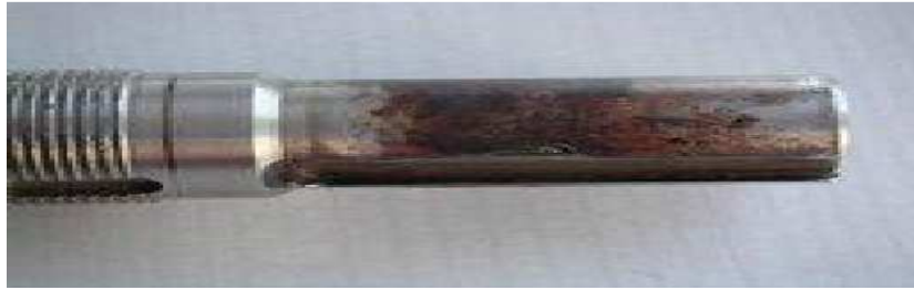
Figure III-10 Exemple d'usure par corrosion
