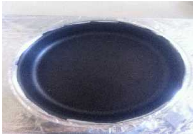
Fig.IV.13 : La marmite entourée de l'MCP et isolation
