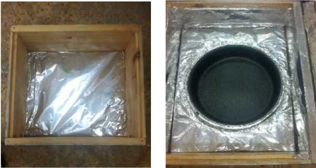
Fig.IV.12 : Le boîtier au cours d'isolation
