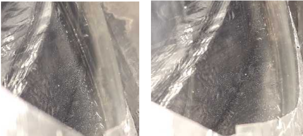
Fig.v.7. La condensation sur les parois latérales de la marmite par le test lampe 200w
