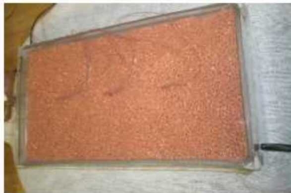
Fig.III.10. Mousse de cuivre à imprégner de MCP [31].
