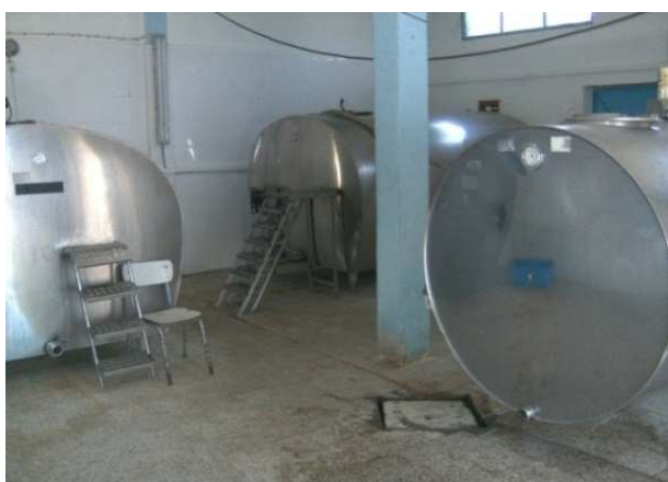
Photos 7 et 8 - La salle de stockage et de refroidissement du lait (03 tanks réfrigérants à 4 °) et un poste de réception du lait (refroidisseur à lait) appelé aussi bac de lancement
