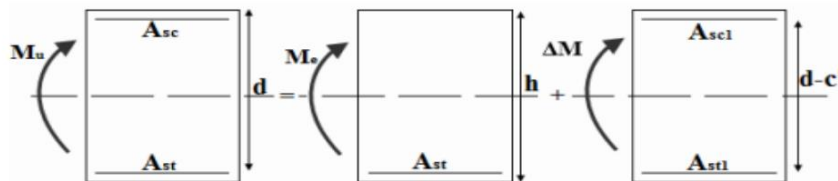
Figure V.1.2 : Section doublement armée.
