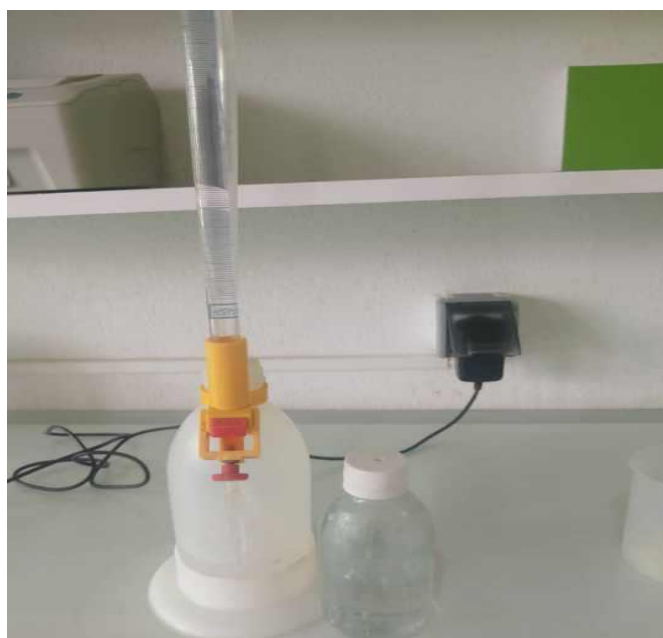
Figure 11 : Mesure de l'acidité par titrage
