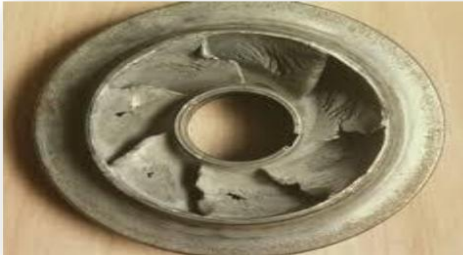
Figure 6.9 : Photo illustrant le phénomène de cavitation sur des aubes d'une pompe centrifuge
