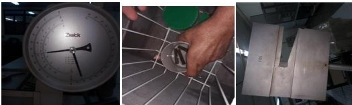
Figure 41: Les étapes de l'essai : étalonnage de l'appareil, et placer le pendule charger à 50 (J) puis placer les éprouvettes qui sont à -20^{\circ}\text{C} sortie du congélateur sur les portes échantillons.
