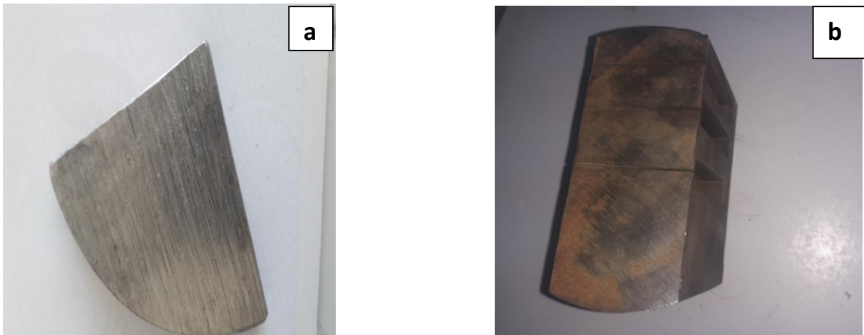
Figure 20: Eprouvettes sciées en trois fois pour les essais mécaniques ; b. pièce extraite d'un rond plein pour éprouvettes de résilience.
