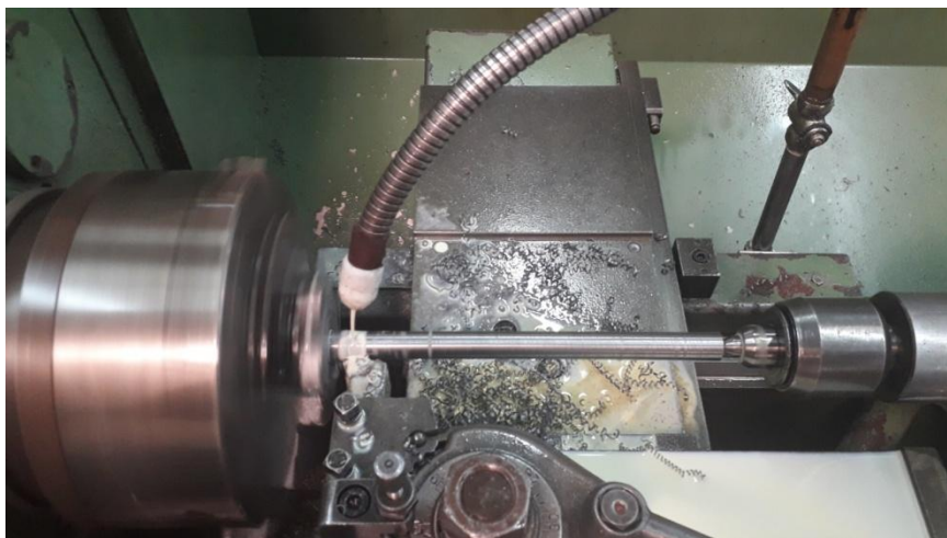
Figure 22: Tour lors de la réalisation d'une éprouvette pour l'essai de Traction
