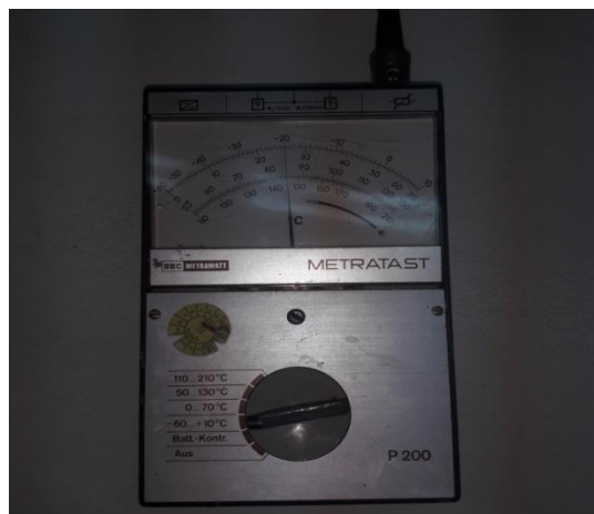
Figure 48: Le Thermocouple a température négatives et positives
