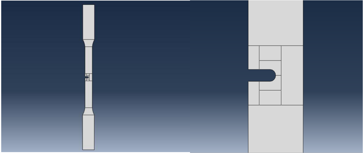
Figure III-2:partition d'éprouvette avec une entaille en U
