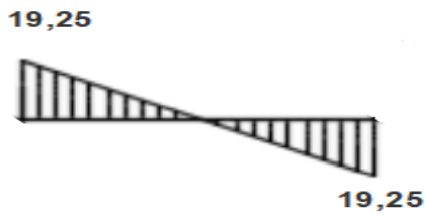
Figure III.2.14 : Diagramme des moments fléchissant à l'ELU
