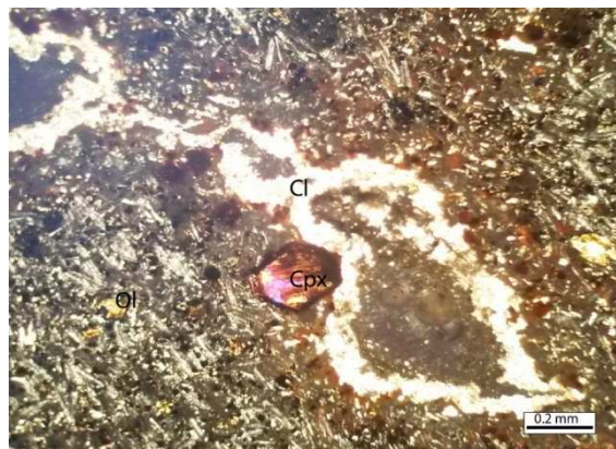
Figure III.22. Texture microlithique vacuolaire à phénocristaux de clinopyroxènes et de la calcite secondaire (Cl) en LPA G×
