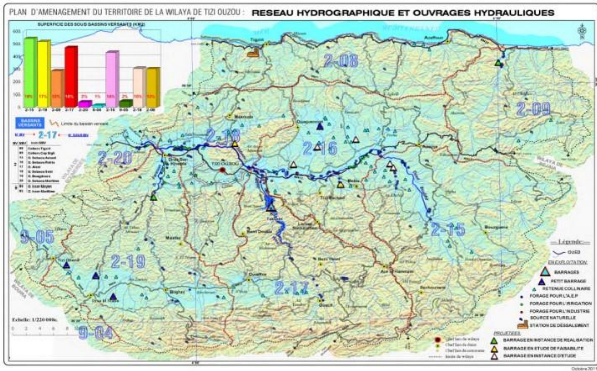
Figure 8. Réseau hydrographique et ouvrages hydrauliques
