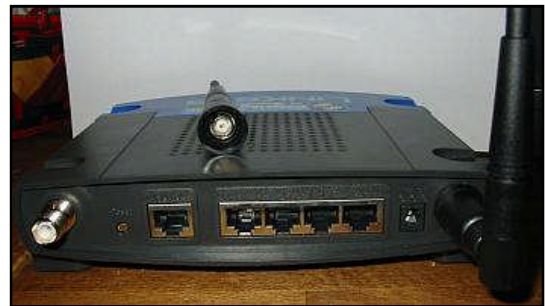
Figure I.7b : point d'accès (vue arrière)
