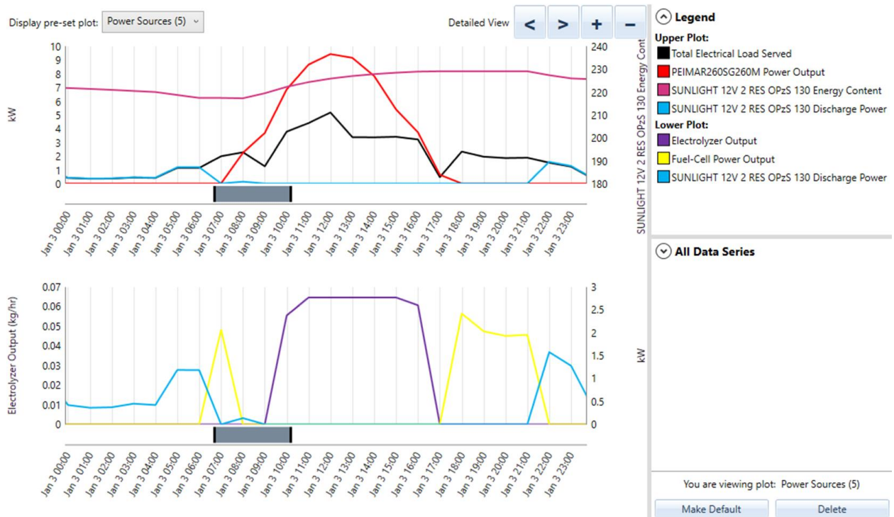
Figure III.16 : Profil énergétique pour la journée du 3 janvier
