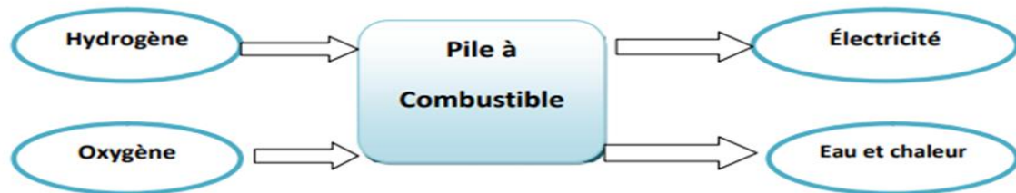
Figure I.9 : Production d'électricité à partir d'hydrogène [7]
