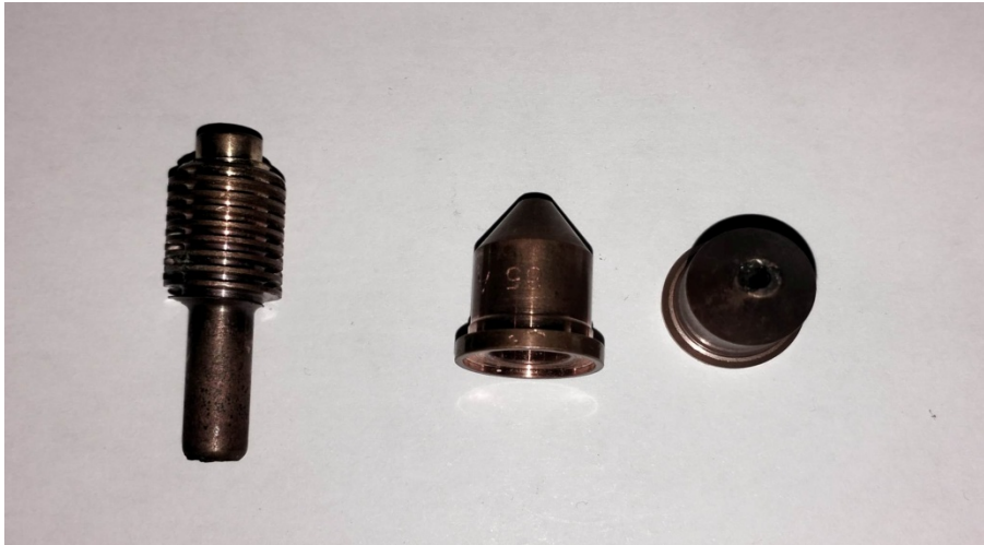
Figure II. 3: Une électrode en cuivre avec deux buses plasma.
