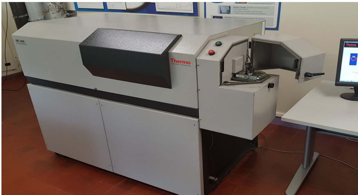
Figure II. 5: La spectroscopie d'émission optique.
