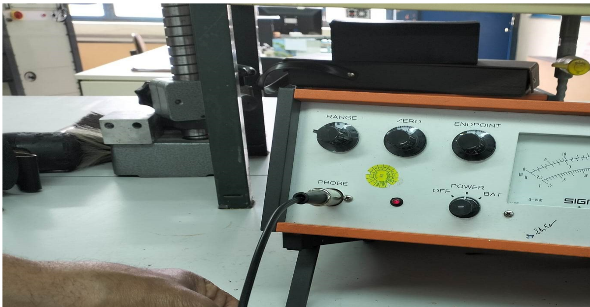
Figure II. 8 : Conductimètre de Sigma-Scope.
