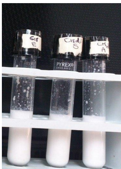
Figure 5.9. Emulsions 1-C18H37SO3Na- Huile (Ether de dicapryle, soja, amande douce) après 1 mois de vieillissement
