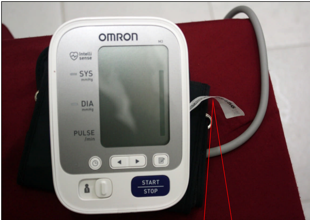
Image . 05: Collage d'étiquette code barre RFID sur Equipment Tensiomètres de la marque OMRON
