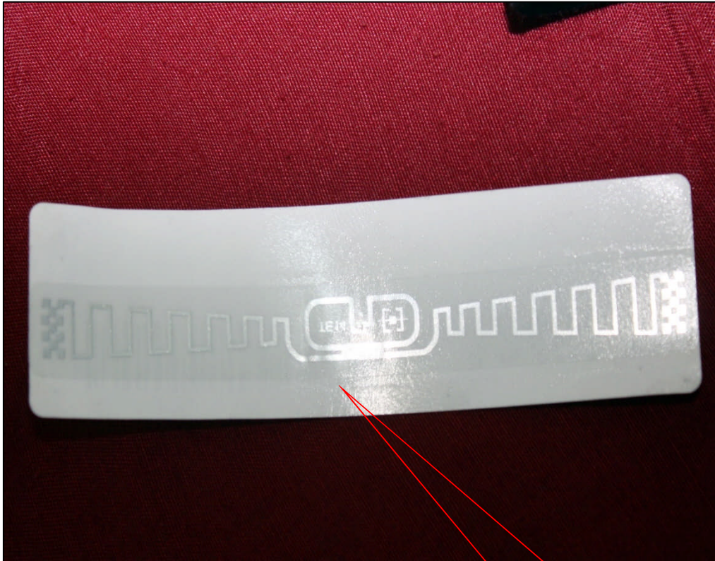
Image. 03: Circuit électronique de Radio Frequency Identification (RFID)
