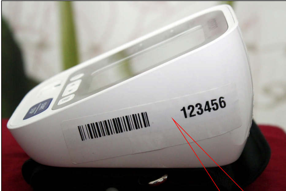
Image. 06: Etiquetage avec marquage permanent et infalsifiable Et code barre Radio Frequency Identification (RFID) CHU Tizi-Ouzou
