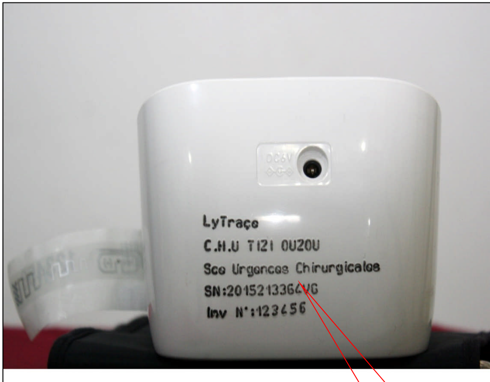
Image . 04 : Etiquetage avec marquage permanent et infalsifiable et système Radio Frequency Identification (RFID) CHU Tizi-Ouzou
