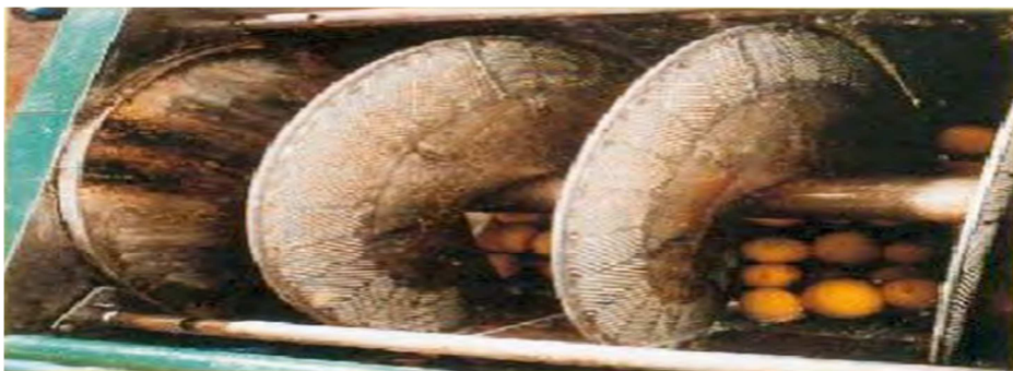
Figure 08 : presse hydraulique utilisée dans l'expression à froid
