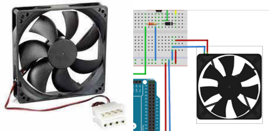
Figure II.9 : Un ventilateur connecté à Arduino avec le logiciel Fritzing.
