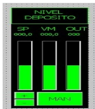
Figure III.6: Exemple d'un faceplate d'un régulateur.
