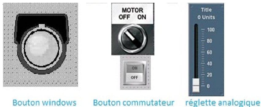
Figure III.5 : Différentes formes de boutons dans une application de supervision.
