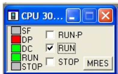
Figure V.4 : Mise en marche de la CPU.
