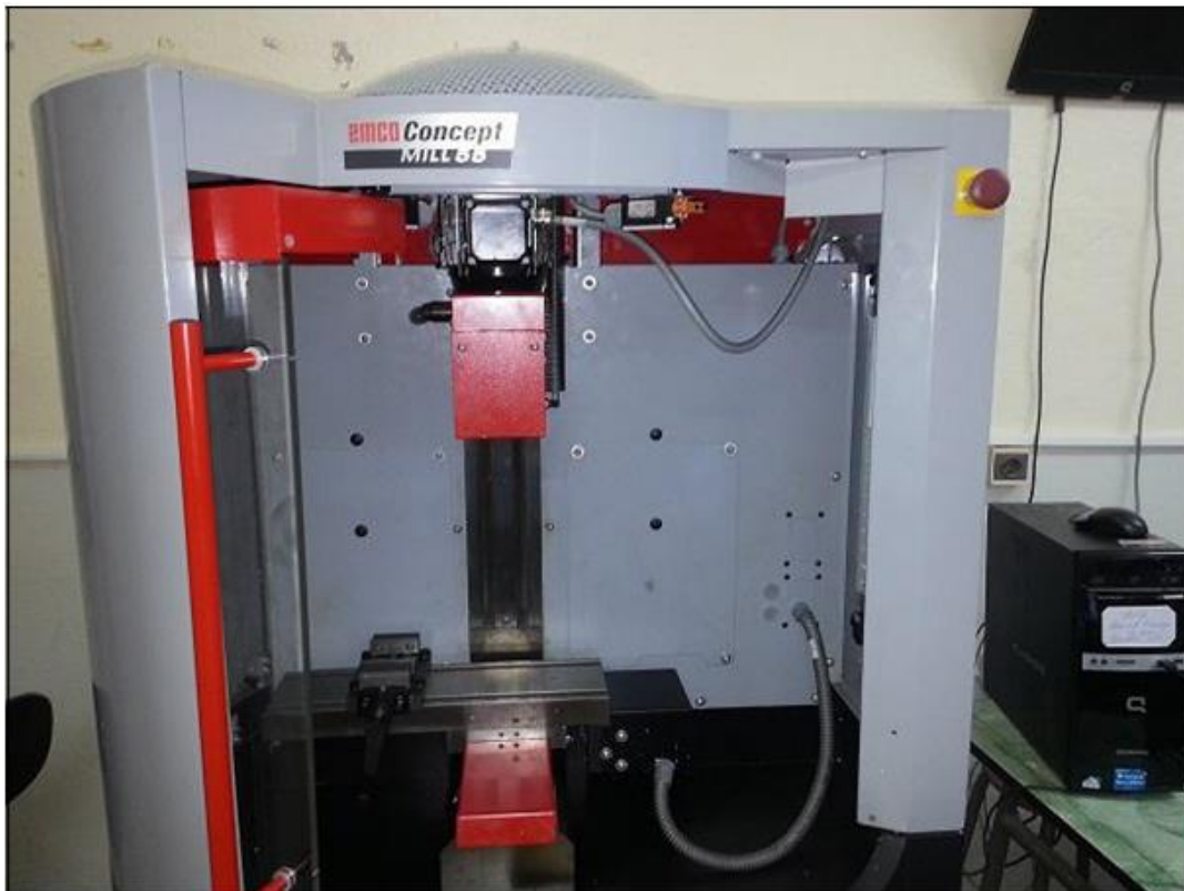
Figure IV.5 : Fraiseuse 2axes et 1/2, EMCO Concept MILL55, à commande Siemens 810M
