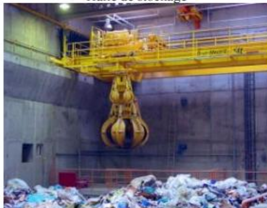
C- Pont roulant avec grappin et palan auxiliaire pour centrale d'incinération
