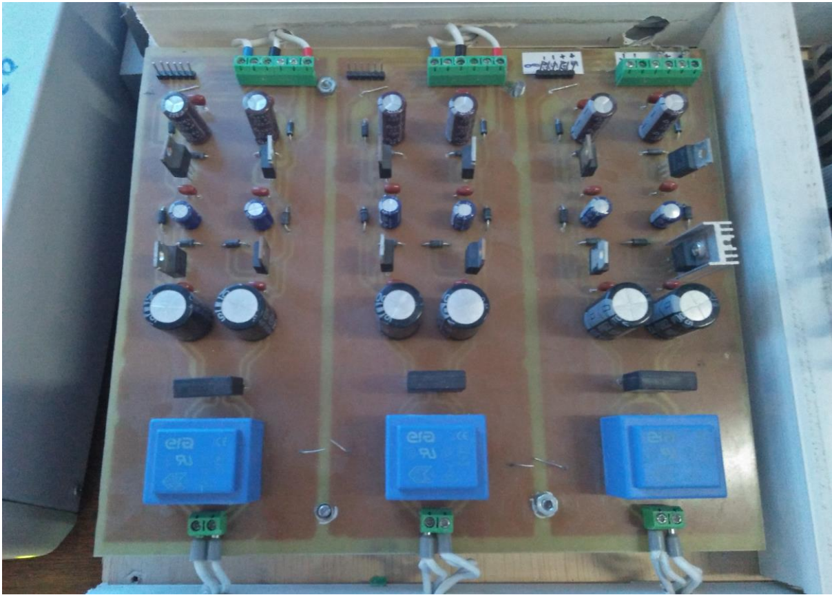
Figure (IV.11.b) : Carte d'Alimentation Stabilisée +5 V, +15 V, -15 V.
