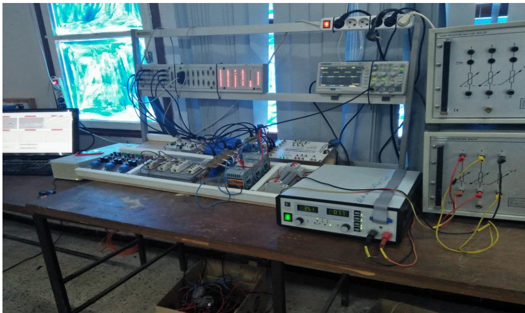
Figure (IV.12.b) : Montage Final de l'Alimentation du Véhicule Electrique
