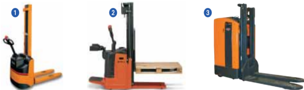
Fig. I.5 : Différents types de gerbeurs.
