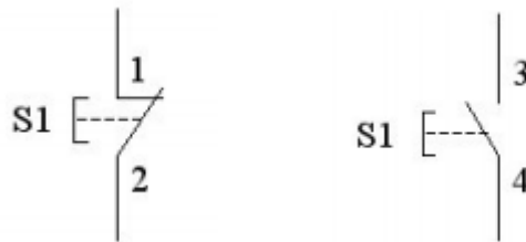
Fig. II.16 : Symbole de bouton poussoir NC et NO.
