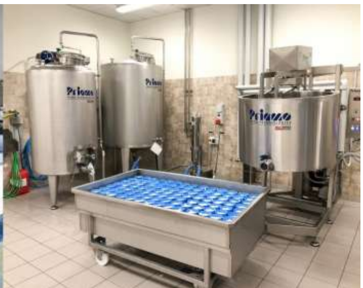
Figure 02 : Citerne de stockage du lait cru
