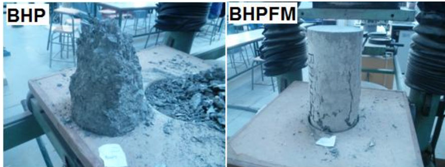
Figure 5 : Rupture à la compression du BHPFM comparée au BHP.
