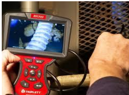
Figure 10 : Caméra d'inspection au boroscope haute définition 5.5mm, 5M Câble (Triplet) .
