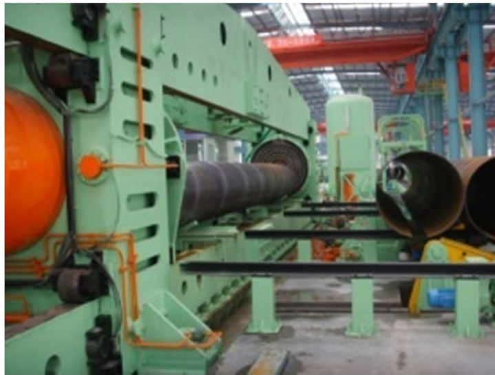
Figure II.5 : la machine test hydrostatique.
