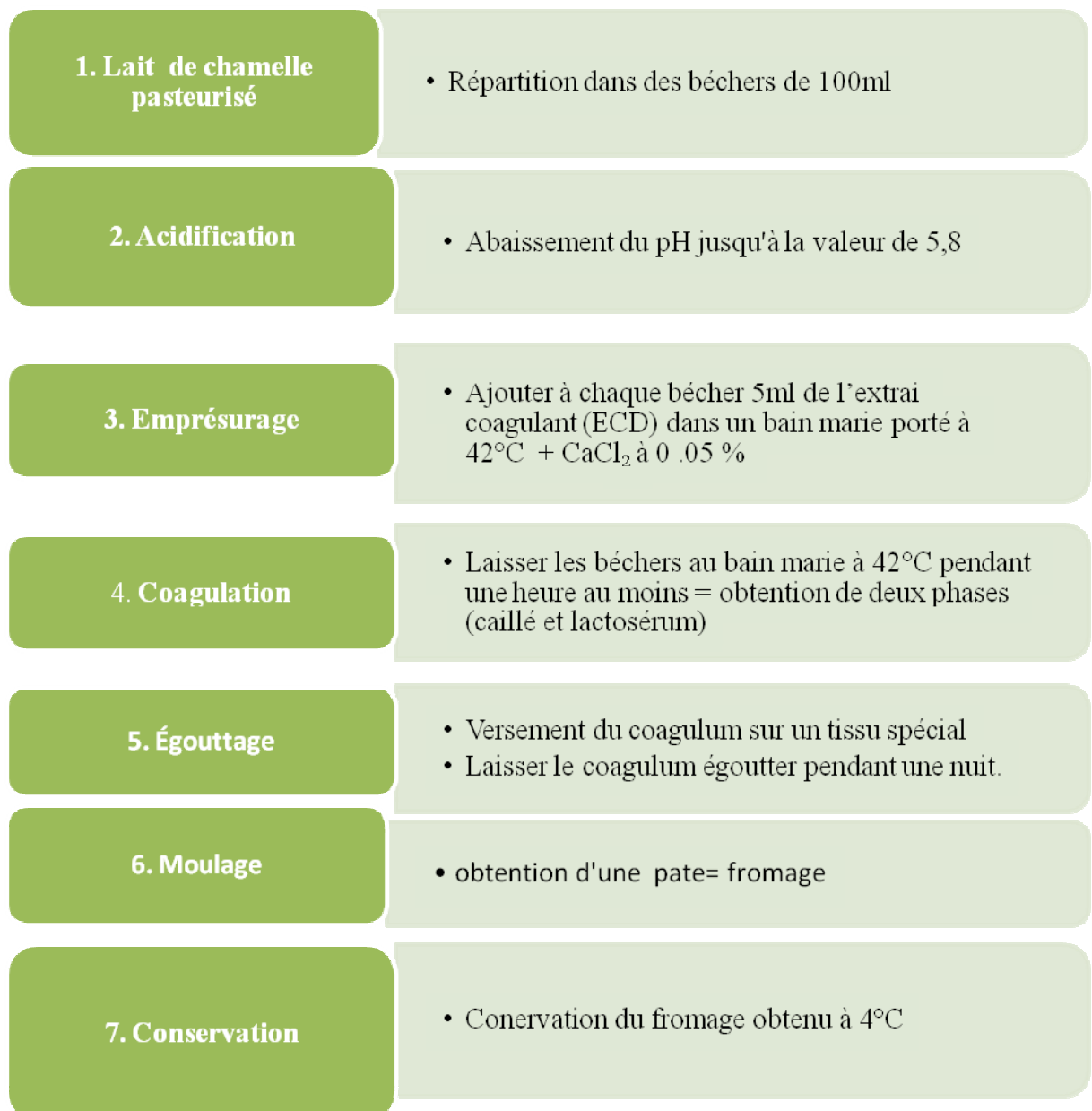
Figure 31 : Etapes suivies au laboratoire pour la fabrication d'un fromage au lait camelin en utilisant les extraits enzymatiques coagulants isolés de caillettes de dromadaire adulte (pH =5.8 ; température = 42°C).
