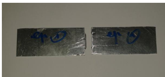
Figure.III.13.a) :Éprouvettes en 1050A après cisaillement sur plat
