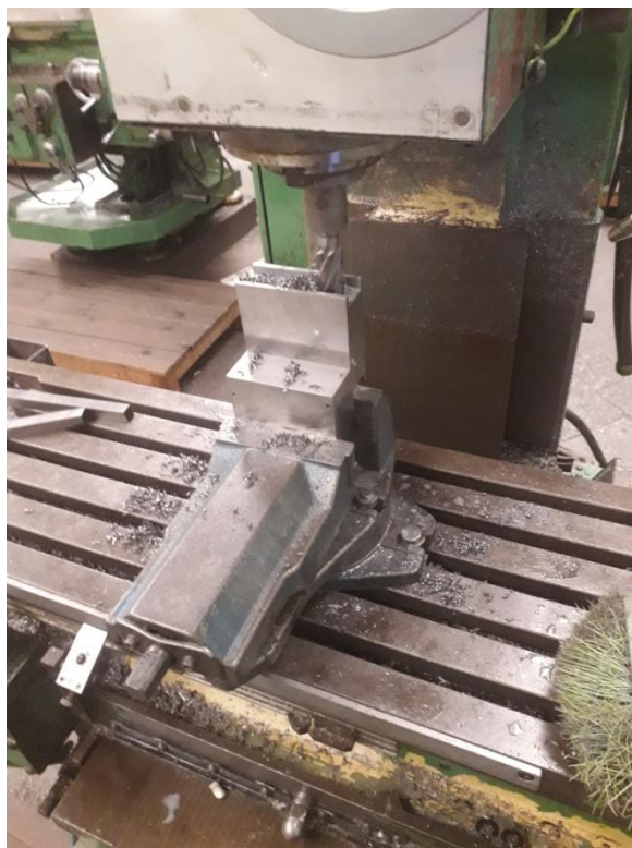
Figure.III.1.a) : Rainurage du socle inférieur
