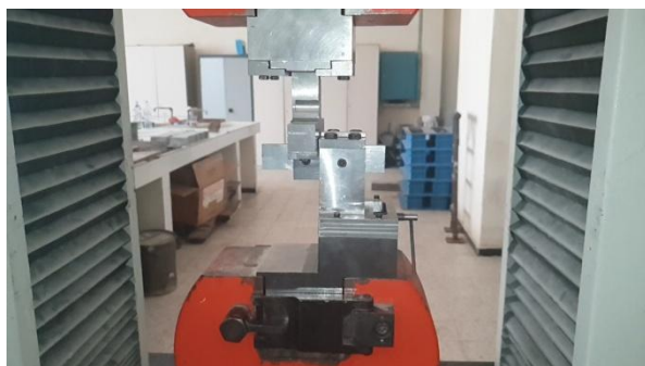
Figure.III.12.a) : Montage sur champ de l'éprouvette
