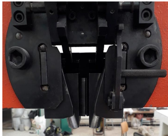
Figure.I.5.b : Dispositif de traction sur le mors mobile
