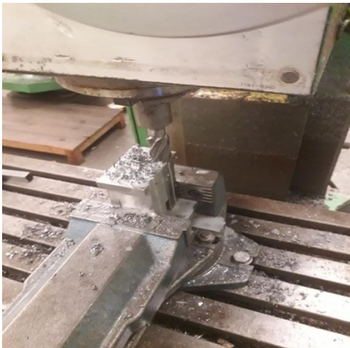
Figure.III.5.a) : Surfaçage du support bride (inf)
