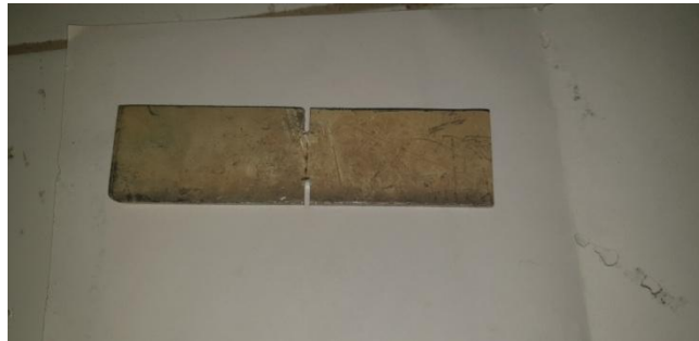
Figure.III.11 : Éprouvette en alliage d'aluminium 7075
