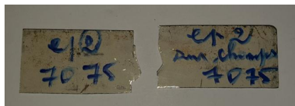
Figure.III.14.b) : Éprouvettes en alliage 7075 après cisaillement sur champ
