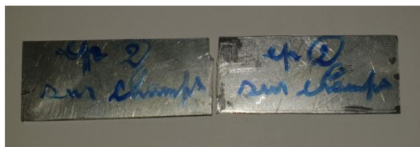
Figure.III.14.a) : Éprouvette en 1050A après cisaillement sur champ
