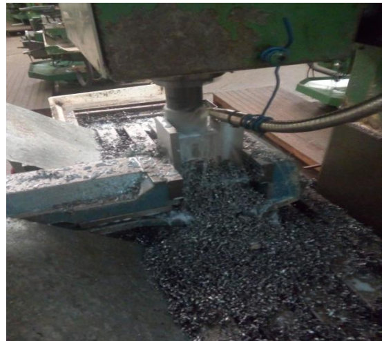
Figure.III.5.b) : rainurage du support bride (sup)
