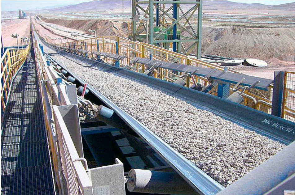
Figure. 10. Transport de la matière première par convoyeur à bande
