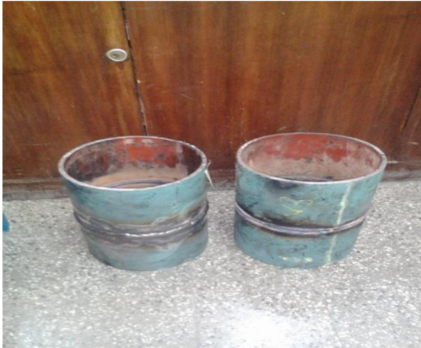
Fig IV.1 : Tubes en acier X42 utilisés dans l'opération de soudage
