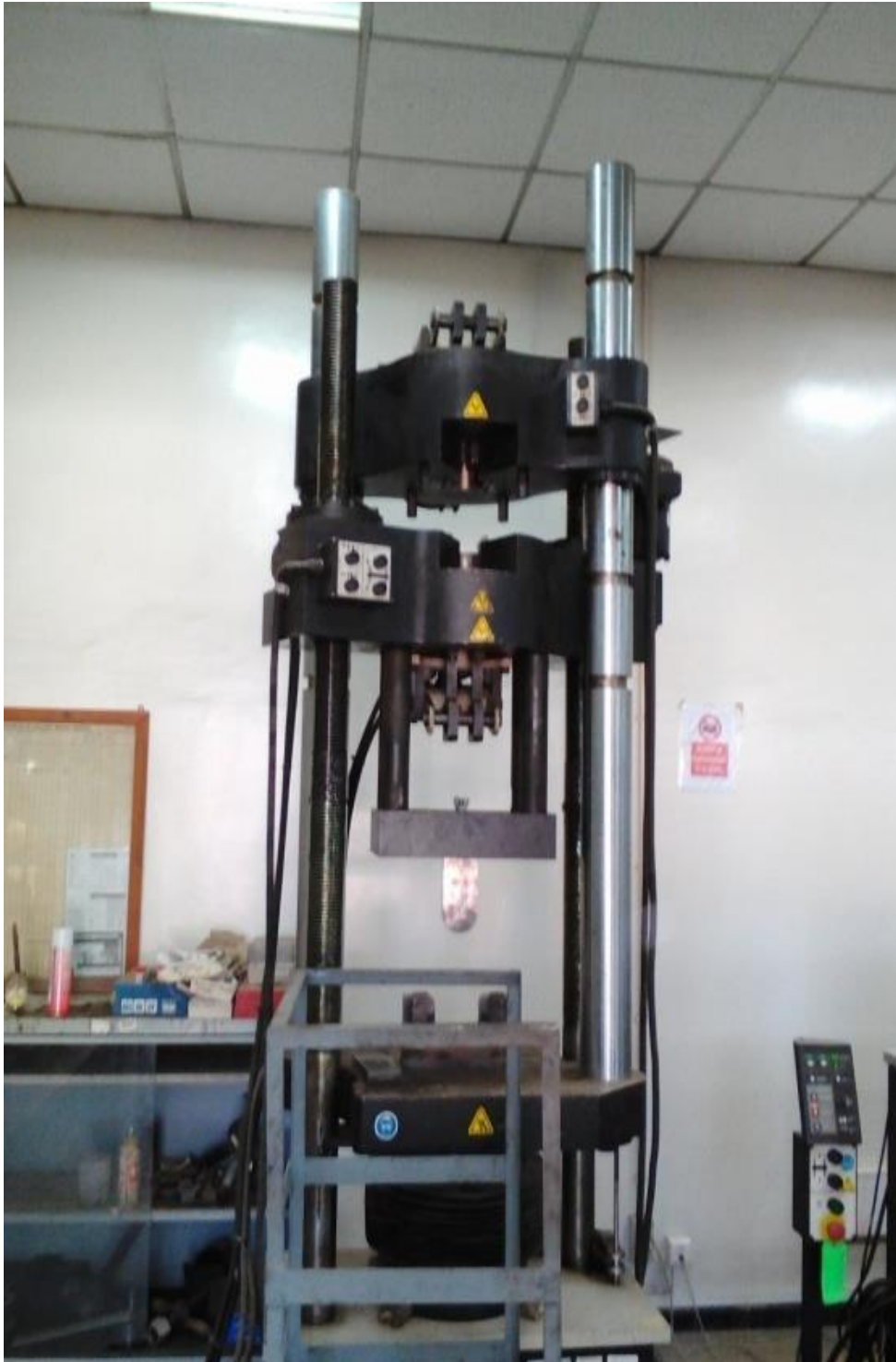
Fig IV.4 : Machine de traction (INSTRON WALPERT)
