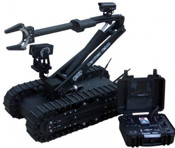
Figure 6: Robot Tactique / Surveillance Mastiff HD2-S avec Bras 5 Degrés de Liberté SuperDroid
