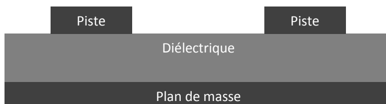
Fig. I.11 : Exemple de coupe transverse d'une carte simple couche avec plan de masse
