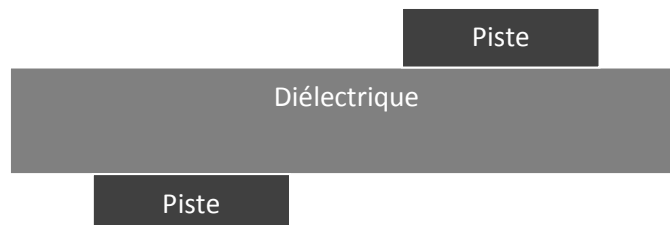
Fig. I.10 : Exemple de coupe transverse d'une carte simple couche, double face, sans plan de masse
