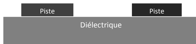
Fig. I.9 : Exemple de coupe transverse d'une carte simple couche, simple face, sans plan de masse
