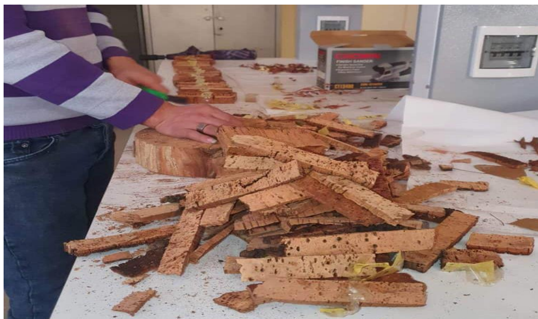
Figure 18 : découpage des éprouvettes de liège sur dimension de 10*1.5cm
