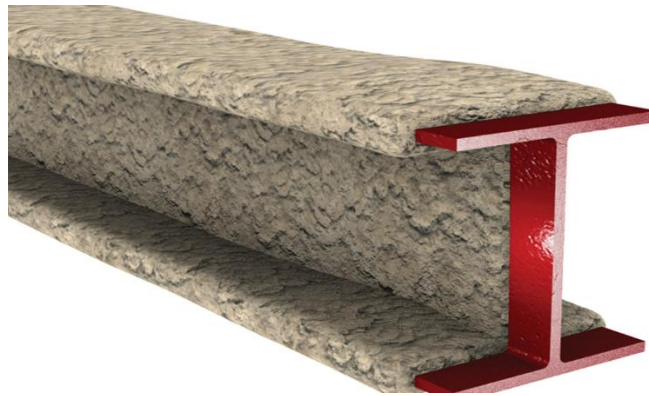
Figure IX.3 : mortiers projetés résistants au feu
