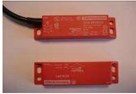
Figure I.21 : Détecteur de sécurité couverte bac lavage.
