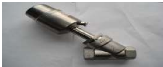
Figure I.20 : Vanne pneumatique rinçage final réseau.
