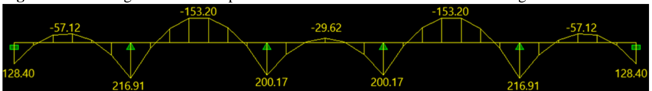
Figure VI.13: Diagramme des moments fléchissant à L'ELS dans le sens longitudinal.
