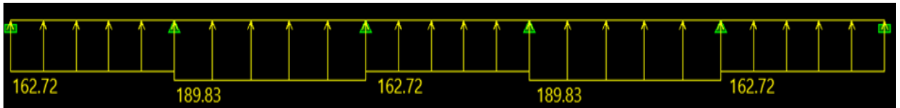
Figure VI.14 : Chargement à l'ELS pour les efforts tranchants dans le sens longitudinal.
