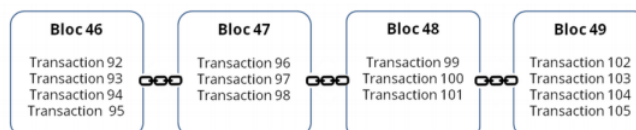
FIGURE 2.1 – Représentation d'une chaîne de blocs.
