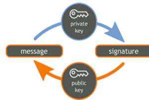
FIGURE 2.7 – Le chiffrement et la signature par la paire de clés.
