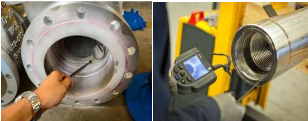
(a) Miroir d'inspection (b) Système visuel
