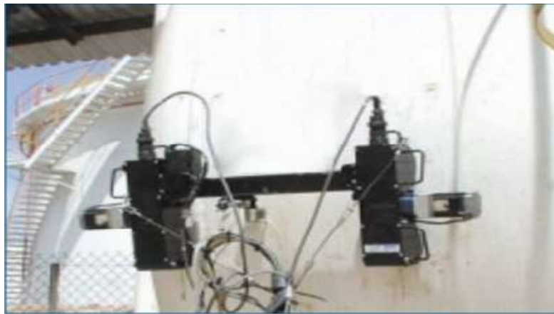
Figure II.8. Principe de CND par l'émission acoustique [25]
