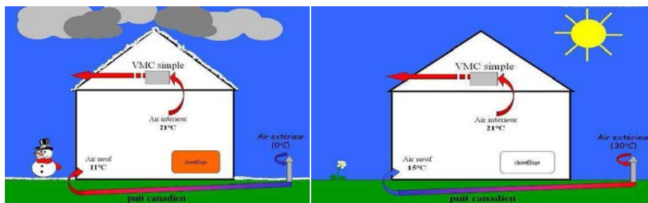
Figure 7 : fonctionnement de puits canadien en hiver/été.
