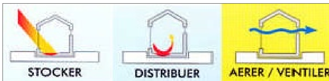
Figure 15 : bonne utilisation de l'inertie thermique d'un bâtiment
