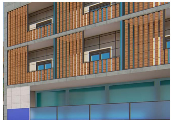
Figure 32 : brise soleil verticale Source : traité par l'auteur
