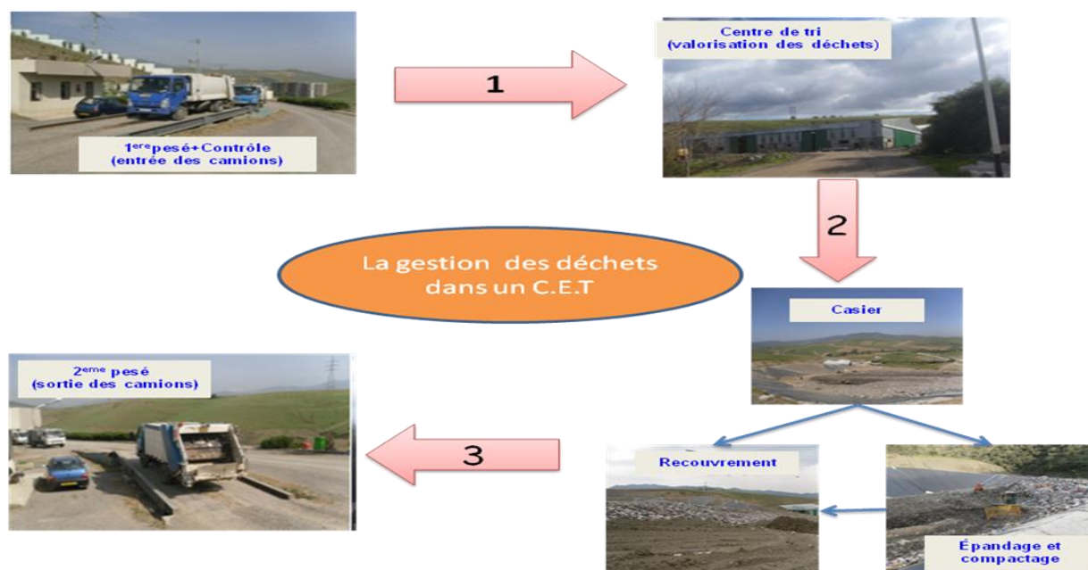
Figure N°05 : Le parcours des déchets dans le CET de Oued Falli.
