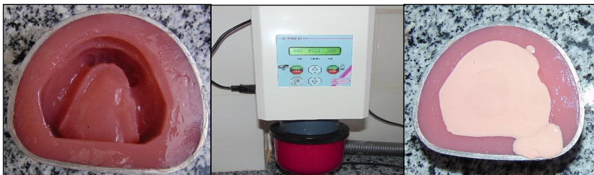
Figure :Coulée de la duplication en matériau de revêtement
