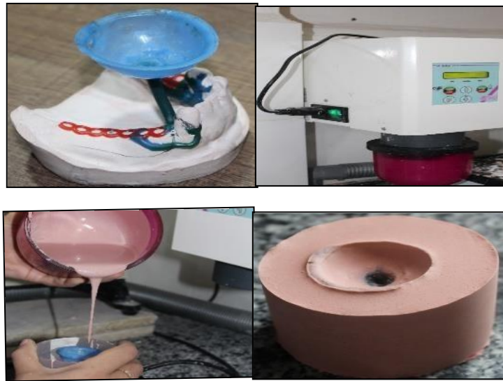
Figure : Mise en cylindre du modèle de la maquette (Document : source personnelle).
