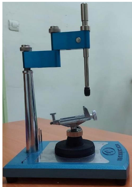
Figure : Paralléliseur : instrument de diagnostic et de traitement
