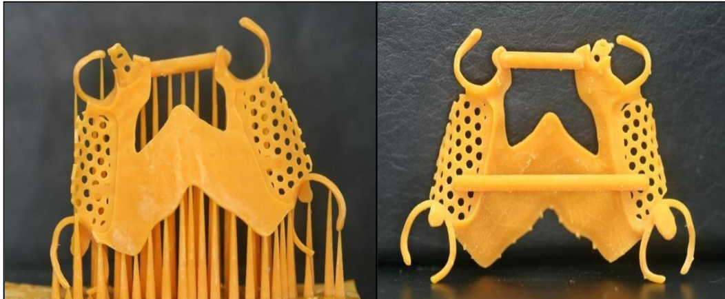
Figure 74 :Maquette en cire réalisée par impression 3D
