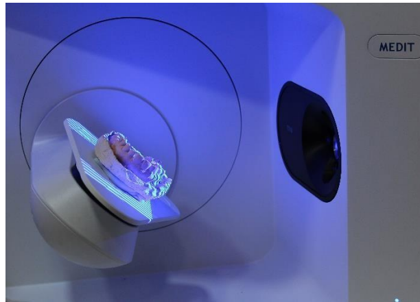
Figure : mise en place du support sur le bras rotor du scanner MEDIT T710 (source : document personnel).
