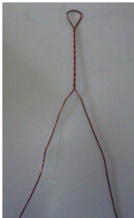
Figure III.4. Boucle formée de la torsade confectionnée avec le tour à bobiner
