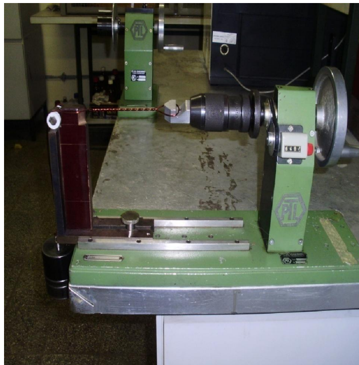
Figure III.3. Tour à bobiner avec échantillon en cours de réalisation.
