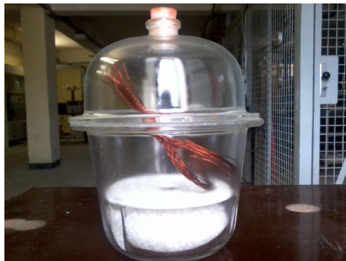
Figure III.11. Ensemble dessiccateur et échantillons en cours de conditionnement.
