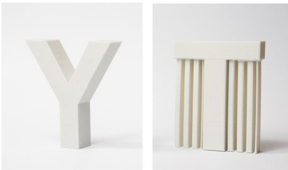
Figure 15: Y et H imprimés en FDM avec support. [20]
