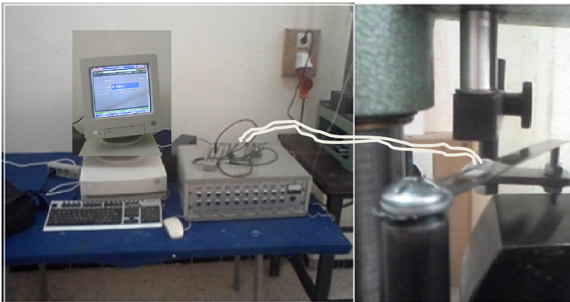
Fig IV.7 : Le capteur de déplacement et la chaîne d'acquisition au cours d'un essai
