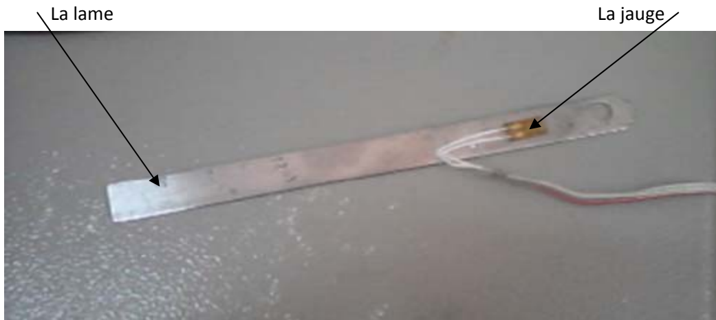
Fig IV.3 : La lame fléchie et la jauge d'extensométrie
